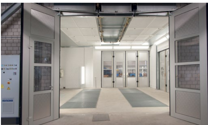
Lackierkabine mit Handhängebahn.
