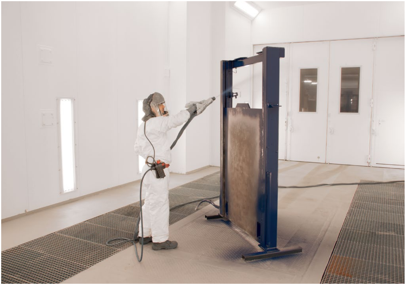
Ideale Arbeitsumgebung. Der Farbnebel wird zuverlässig abgesaugt, und Lackierdämpfe sind während des Betriebes kaum wahrnehmbar.
