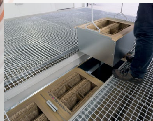
Paintblockfilter in der Unterflurvariante. Die ergonomische Handlinghilfe (optional) vereinfacht den Filterwechsel.
