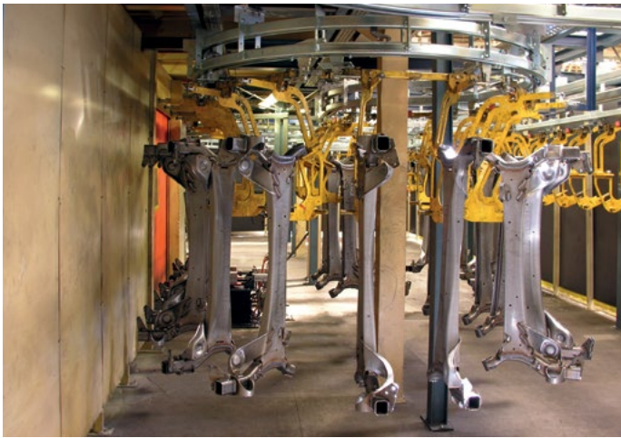
Power and Free Förderer im Einsatz.
