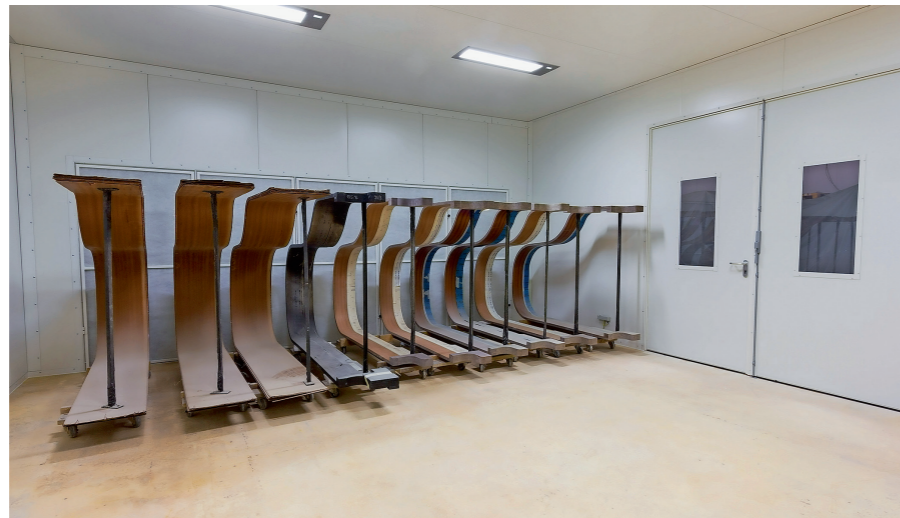
Moderne Technik für die anspruchsvolle Verarbeitung des Klavierlacks: Im Trockenraum kann der sensible Polyesterlack kontrolliert abtrocknen.
