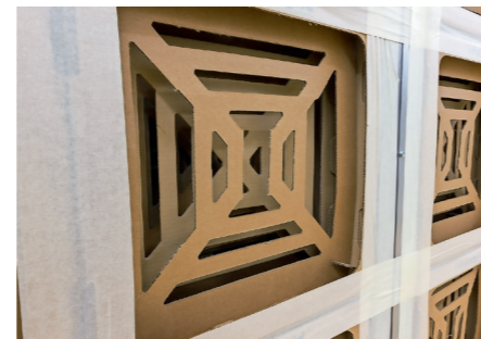
Die 36 m 2 große Lackierkabine mit den „Paintgrid“-Vorabscheidern.
