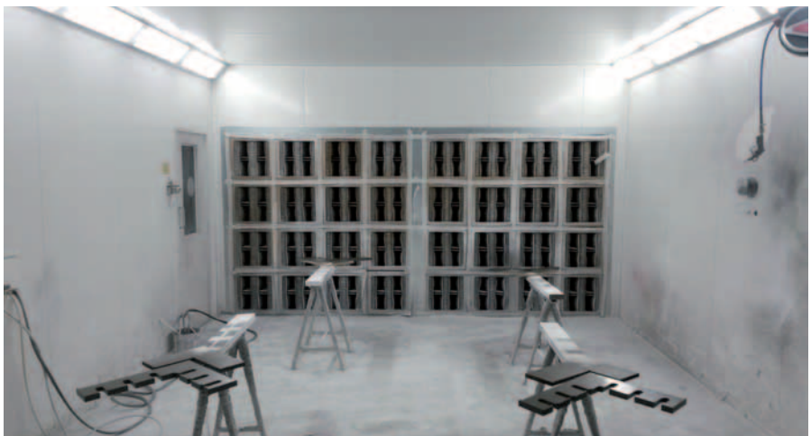
Mehr Lackieren, seltener Filter wechseln: Die Lackierkabine mit den Paintblock-Filterwürfeln schafft optimale Arbeitsbedingungen und reduziert die Entsorgungskosten von Overspray.
