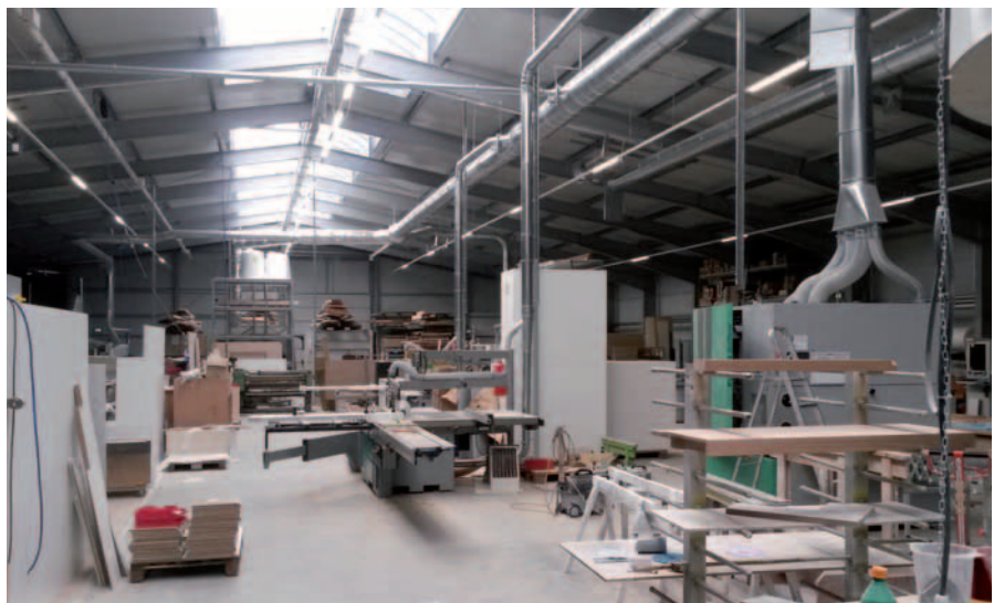
Der Werkstattbereich bei Padati wird über zwei Absauglinien entstaubt.
